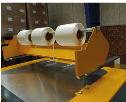
Porte-attaches monté sur le haut vous permet d'installer votre presse contre le mur.
