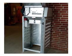
La capacité peut être ajustée en fonction des besoins individuels en utilisant des grilles de tailles différentes.
