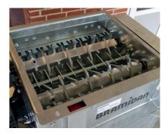
Les barres ou boîtes en polystyrène sont efficacement transformées en granulés par les couteaux montés sur deux axes.
