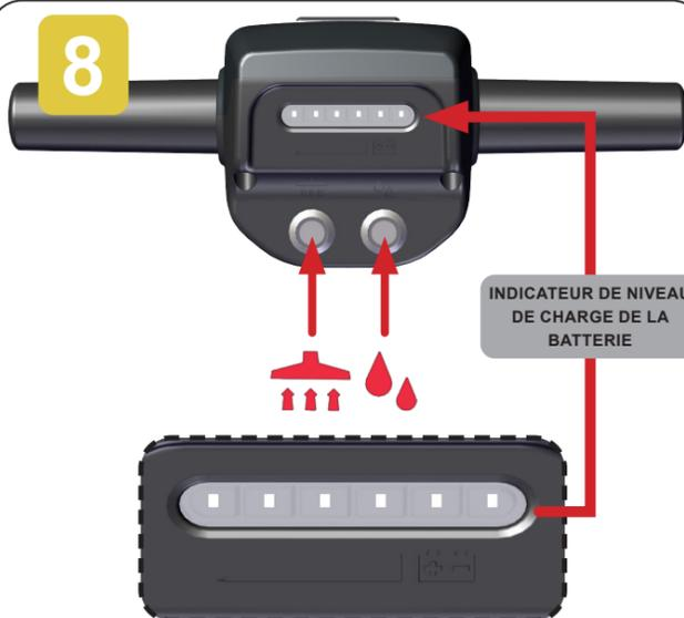
INDICATEUR DE NIVEAU DE CHARGE DE LA BATTERIE
